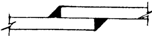
جوش گوشه در اتصال روی هم
